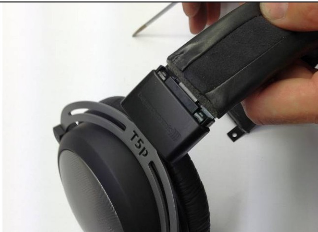
Nach Entriegelung beider Rastnasen kann das Kopfband herausgezogen werden.
